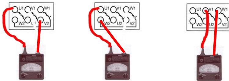
Contrôle d'isolement des bobinages entre eux
